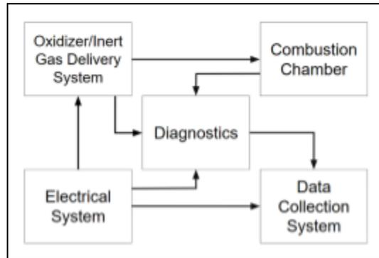
Fig. 7: Test Stand Subsystem Diagram
